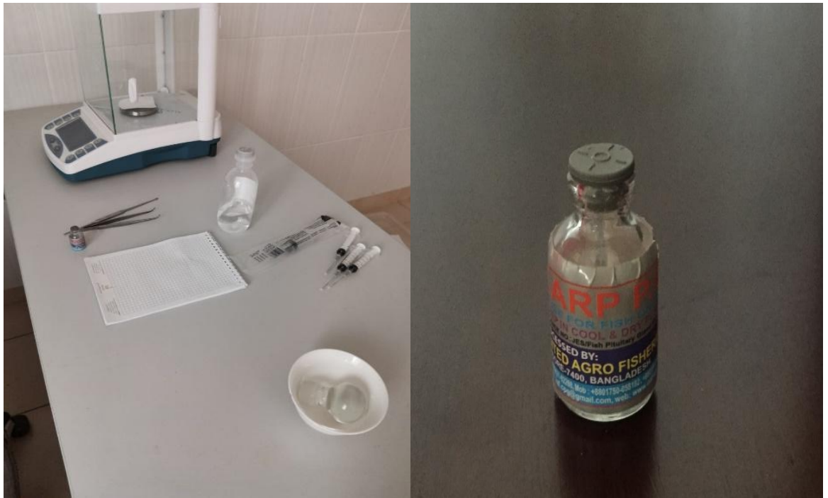
Сурет 9 - Сүйрік өндірушілерін ынталандыру үшін ацетондалған тұқы гипофизі және гипофиз ерітіндісін өлшеуге арналған жабдық
