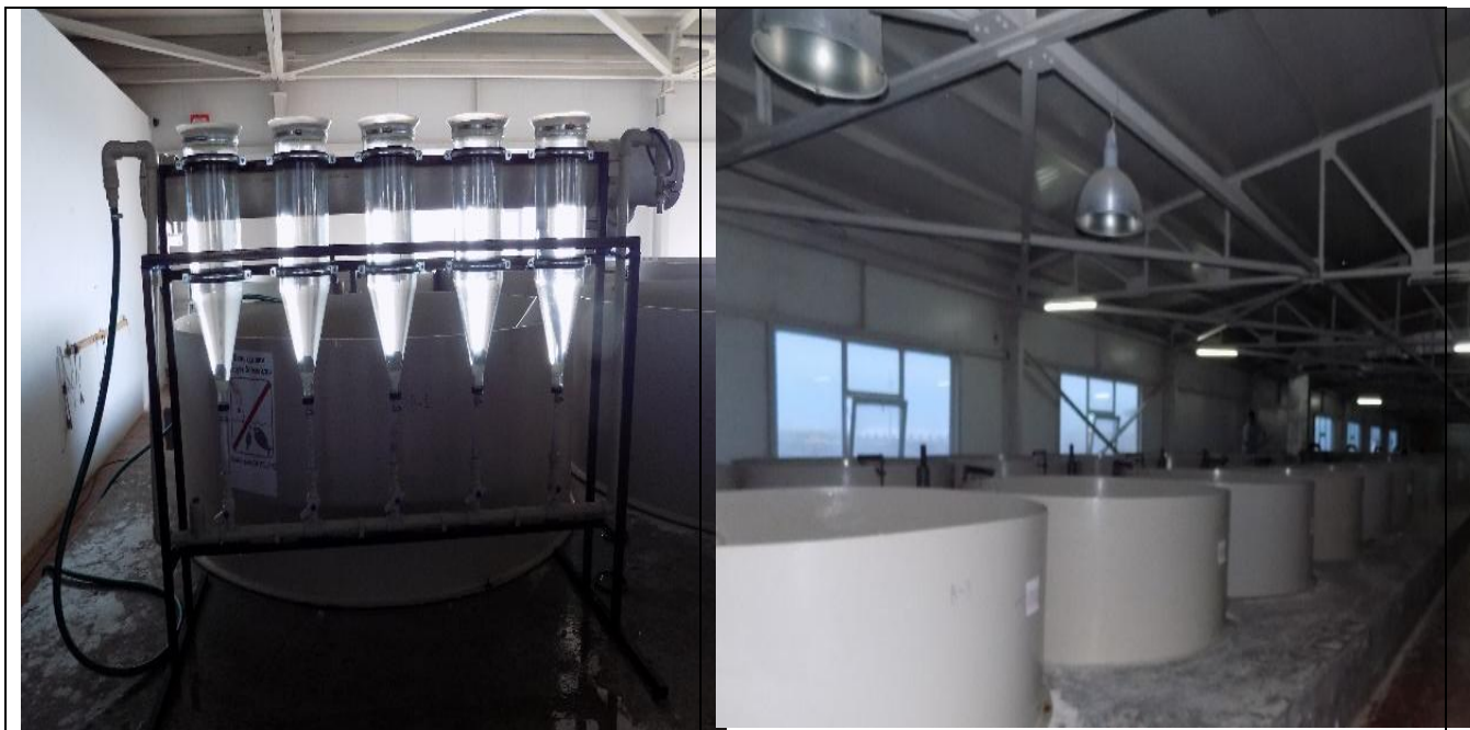
Сурет 5 - Сүйрік личинкаларын өсіру үшін Вейс аппараттары бар бағаналар мен бассейндер
